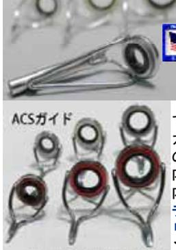
ACSは1980年代のガイドを再生したパーフェクションのショック・リング付ガイドとしてビルダーの間では人気の高いストリッピングです。このガイドはキャスト・ロッドにも使用されております。これはフライ用ではありませんがACSガイド用トップ・ガイドです。クリヤー・ショックリングの外径は8mm、セラミック・リングの内径は約4.1ミリ、差込部分のチューブ内径には現時点では3サイズあります。チューブ内径サイズ: ①2ミリ②2.2ミリ③2.6ミリ。尚、フライ用ストリッピングのACSには①8ミリ税込¥473
