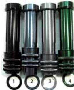
800) さすがストラブル、アメリカの多くのロッド・メーカーの純正品として使われているだけの確りした作りと機能を持っています。内径17.7mm、全長約108mm、コルクに埋め込む部分の上部外径26.2mm。外観の美しさはさすがアメリカ製のストラブルですが、材質と機能性についても大変グレードの高い事は一目瞭然です。大変軽く46.3グラム、材質のアルミは柔軟性に富んでいてリール・フットを傷つけずにじんわりと締め付けます。ナットは外れにくいダブル・ナット、リールの着脱が大変スムーズに行える快適な使い心地です。トリム・リング付き。パンパー等の凝った作りのロッドに適しています。カラー: ①ブラック②ブルー③グレー④グリーン
